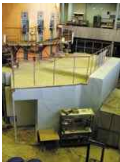
Облучательный бокс на ядерном реакторе МИФИ.
